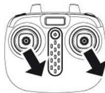
Stellen Sie das Flugzeug auf eine ebene Fläche und bewegen Sie den linken und rechten Joystick in die rechten unteren Ecke für etwa 3 Sekunden. Die Anzeige wird schnell blinken und bleibt dann konstant, um anzuzeigen, dass der Kalibrierungsvorgang abgeschlossen ist.
