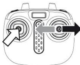
Wenn das Flugzeug im Schwebeflug nach links oder rechts driftet schwebt, halten Sie den linken Joystick gedrückt und drücken den rechten Joystick nach rechts/links, bis das Flugzeug aufhört abzudriften.
