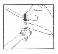
Les lames étiquetées A s'adaptent aux moteurs étiquetés A, les lames étiquetées B s'adaptent aux moteurs étiquetés B. Utilisez les vis pour serrer les lames. Reportez-vous à l'image
