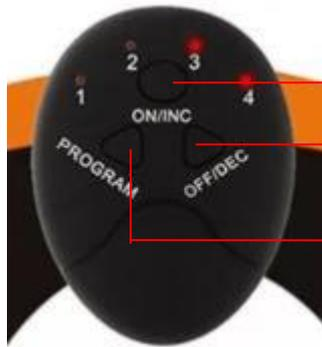
ON : Allumer l'appareil / INC : Augmenter l'intensité
