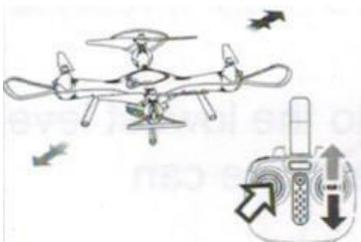
Si le drone se dirige automatiquement vers l'avant ou l'arrière en vol stationnaire, appuyez sur le joystick de gauche tout en dirigeant celui de droite vers l'avant ou vers l'arrière pour repositionner le drone. Maintenez le joystick de gauche appuyé jusqu'à ce que le drone soit de nouveau stable.
