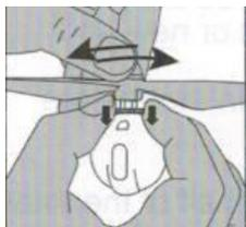
Appuyez sur l'hélice A dans l'axe du pivot puis faites tourner dans le sens antihoraire pour la verrouiller. A l'inverse l'hélice B se verrouille en la tournant dans le sens horaire.
